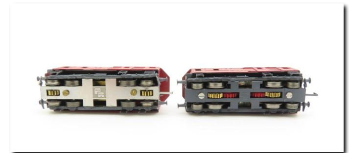
2 x ZF108b, rechts mit neu gestaltetem Antrieb mit starker Untersetzung, letzte Auflage (wurde auch bei ZF108a realisiert)
