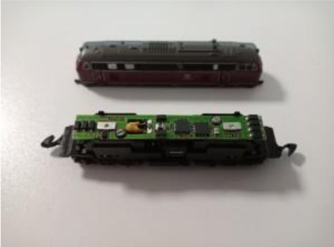
So oder so, wir bauen die Platine aus, indem wir die Schrauben lösen und die Platine vorsichtig heraushebeln (diese wird seitlich durch 4 kleine Kunststoffnasen gehalten und geht evtl. etwas schwer heraus).
