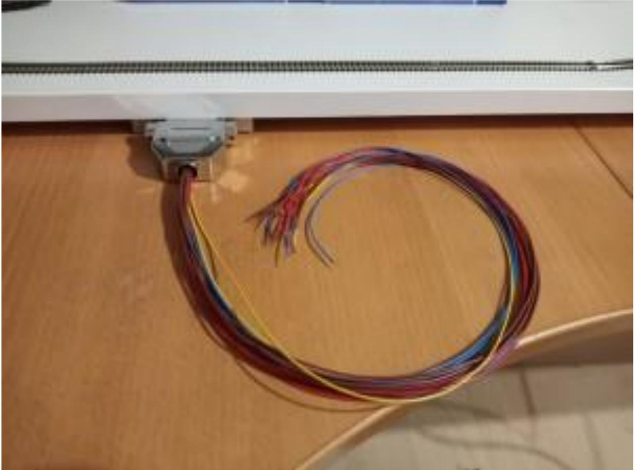
Normal würde ich jetzt empfehlen das Kabel durchzumessen... aber ich bin ja auch etwas faul und so viele Kabel haben wir nicht. Die Kabel für die Blöcke (rot) testen wir direkt im Einsatz. Wenn die Lok an einem Block nicht fährt, wissen wir wo wir suchen müssen. Die Kabel für die Weichen teste ich an einem alten Märklin Trafo, schon alleine um zu wissen welches Kabel für welche Weiche ist (vorher beschriften hätte das erspart, aber zum Test müssen wir eh noch mal durchprüfen):
