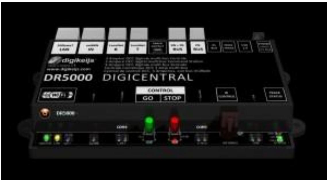
Über den Klick auf "Control" auf dem Bild der DR5000 am PC kann man dann die Lok fahren, Funktionen bedienen, etc.
