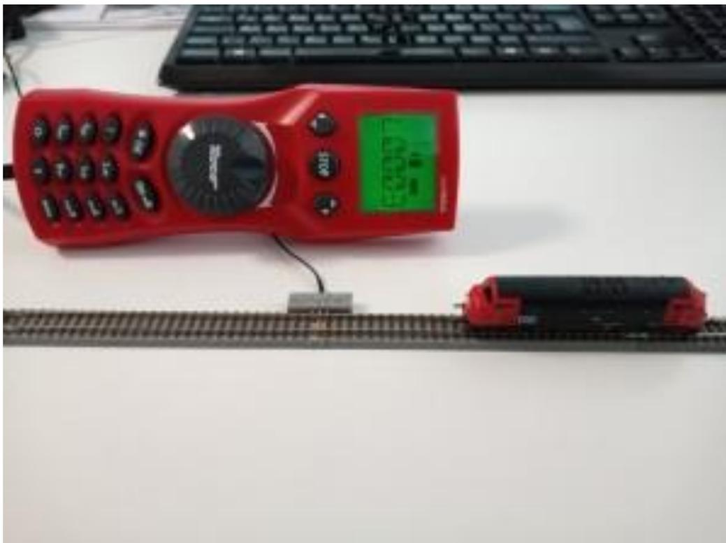
Wenn wir nun NUR die Multimaus mit Gleisbox und Originalnetzteil oder die Mobile Station mit Gleisbox und Originalnetzteil verwendet hätten, dann hätten wir einen [AMW DSR](#) zwischen Gleis Ausgang der Gleisbox und Gleis geschaltet um die Digitalspannung auf Z taugliches Maß zu reduzieren.
