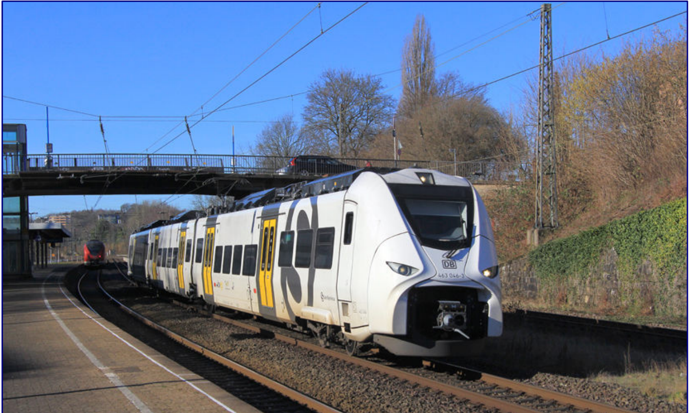
463 046-3 der S-Bahn Rhein-Neckar, ein Hybridzug aus der Siemens Mireo-Familie, ist am 8. Februar 2023 als ST 57389 auf Probefahrt (Wiesbaden - Minden) in Wuppertal-Sonnborn angekommen. Er soll am Schluss dieses Beitrags die derzeitige Renaissance der Speichertriebzüge symbolisieren. Foto: Wolfgang Bügel, Eisenbahnstiftung
