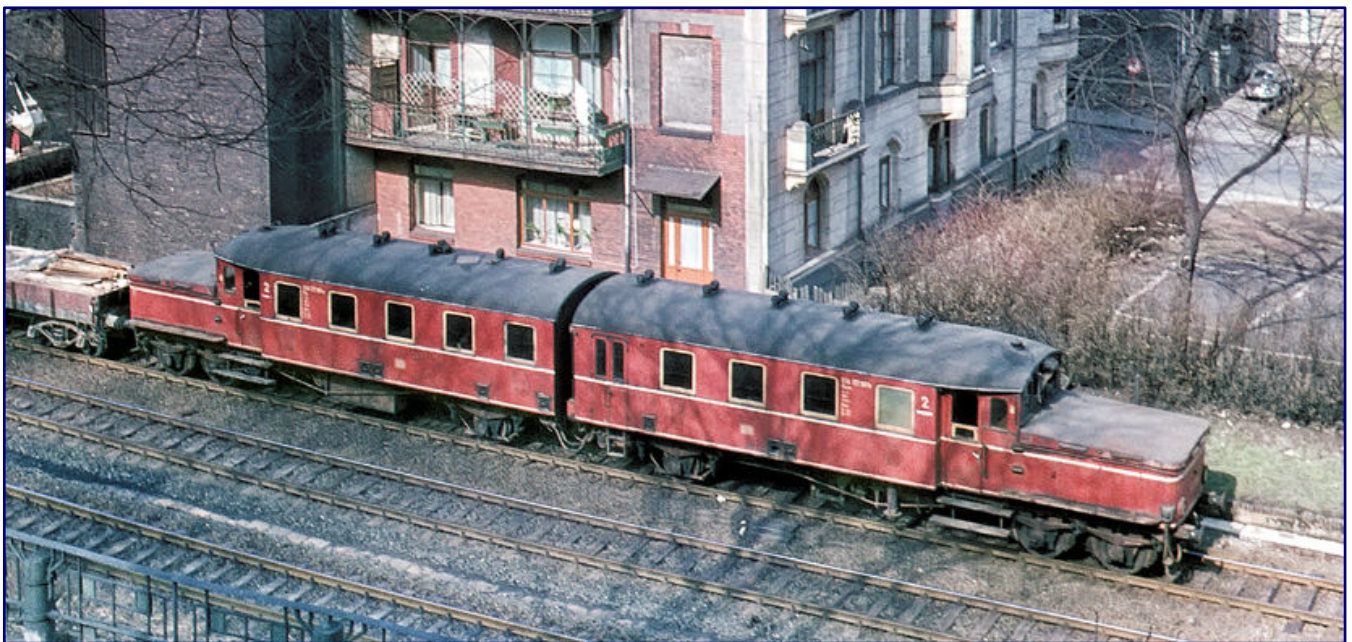
Seit 1907 waren die Wittfeld-Akkutriebwagen in Preußen im Einsatz. ETA 177 101 macht sich im Februar 1963 auf seine letzten Tage im Bauzugdienst bei den Elektrifizierungsarbeiten im Tal der Wupper nützlich. Foto: Carl Bellingrodt, Eisenbahnstiftung
