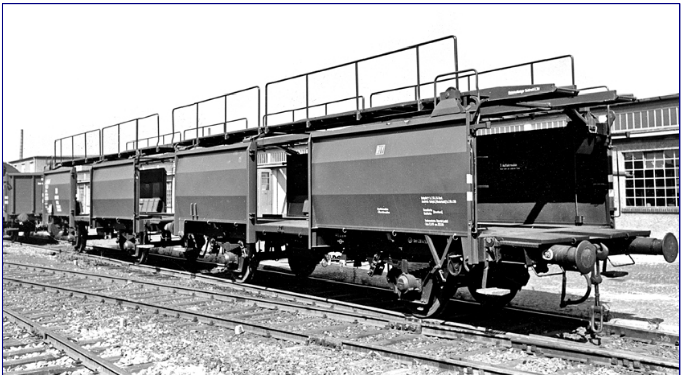
Angeblich datiert diese Aufnahme einer Doppeleinheit Off 52 auf das Jahr 1960. Längst nachgerüstet sind die Geländer an der Ladebühne, aber von den Rastschienen zum Festsetzen der Schalenradvorleger ist im Unterdeck merkwürdigerweise nichts zu sehen. Foto: Bustorff, Sammlung Eisenbahnstiftung.
