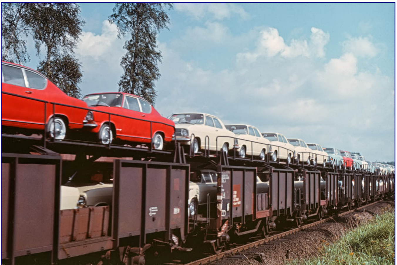
Diese für den Export bestimmten Opel Kadett B wurden von 1965 bis 1973 im Werk Bochum gebaut und sind im September 1965 bei Bramstedt auf Offs 59 unterwegs. Zur Zeit der Aufnahme war der ebenfalls als Provisorium konstruierte Off 52 bereits wieder auf dem Rückzug. Foto: J.B. Snell, Sammlung Eisenbahnstiftung
