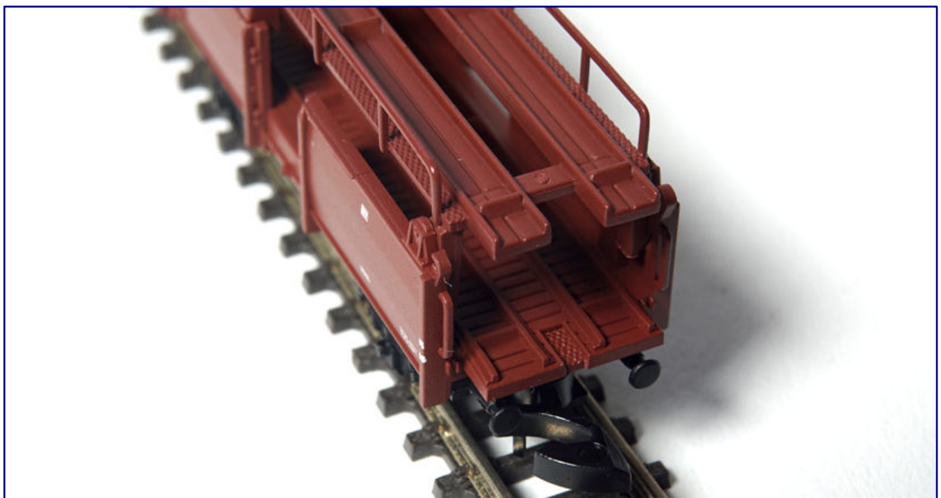
Die Aufsicht zeigt den Holzbelag des Wagenbodens und die Fahrmulden der Ladebühne, jeweils mit Rastschienen und Radvorlegern.
