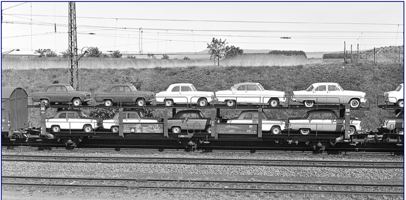
Diese bei Nürnberg am 5. Juni 1959 gefertigte Aufnahme zeigt einen beladenen Offs 55 in seiner ursprünglichen Bauform mit Blechtafeln und Geländern im Unterdeck. Foto: Joachim Claus, Sammlung Eisenbahnstiftung
