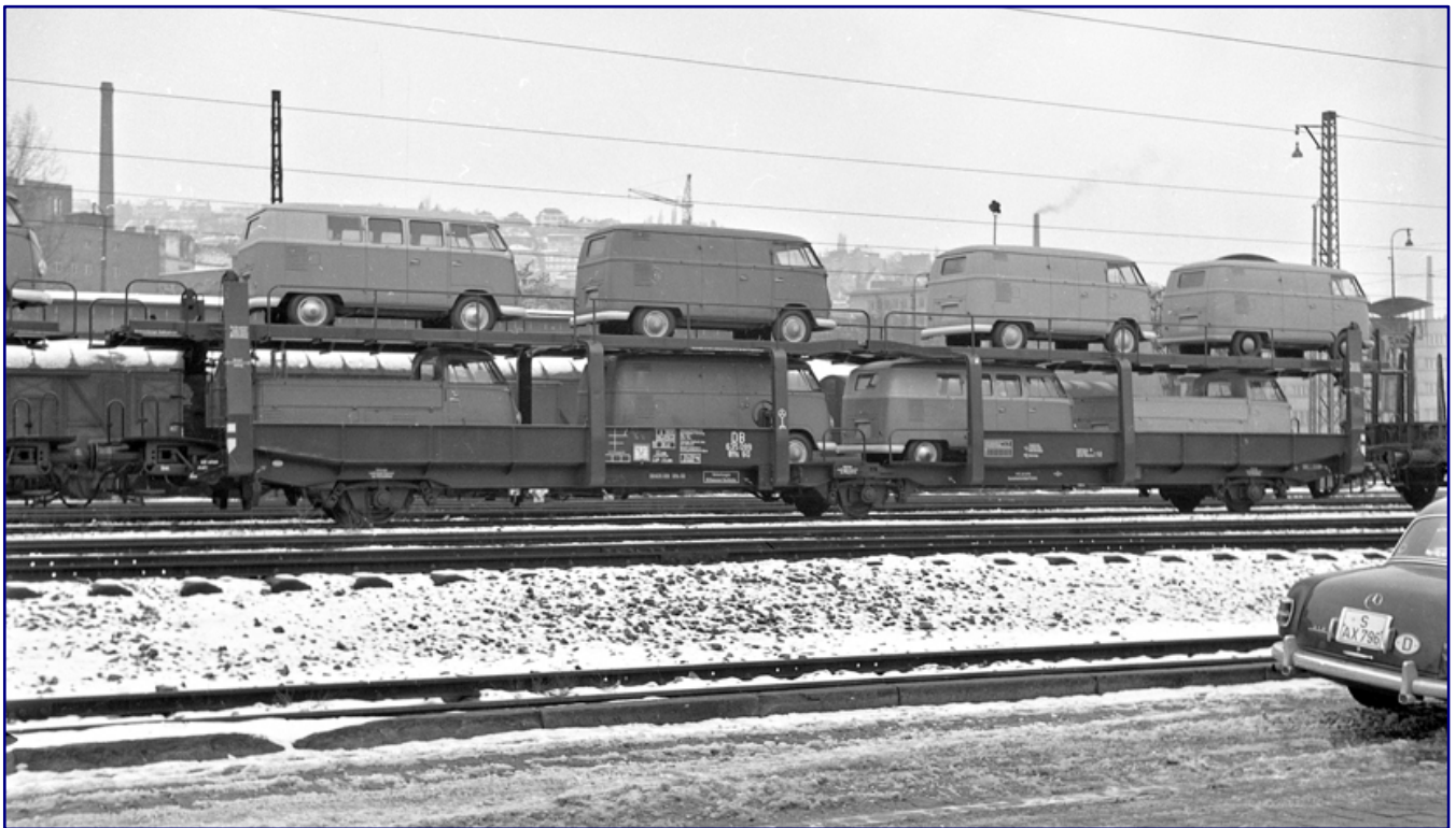
Die Entwicklung des Offs 60 als Wagen der dritten Generation ergab sich aus den sprunghaft steigenden Transportzahlen von Transportern und Kleinbussen zum Ende der fünfziger Jahre. Foto: Fritz Willke | © Stefan Carstens
