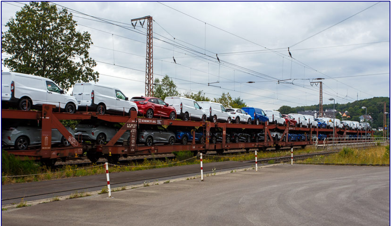
Hier zeigt sich ein Laeeks 553 der DB Cargo Logistics GmbH (ex DB Schenker ATG) am 1. August 2024 im Zugverband bei der Zugdurchfahrt in Wilsdorf-Rudersdorf (Kreis Siegen). Der Wagen mit der Betriebsnummer 25 80 4367 693-5 D-ATG wurde 1988 von der Waggon-Union Berlin gebaut und wurde von der Bundesbahn bei der ATG eingebracht. Foto: Armin Schwarz
