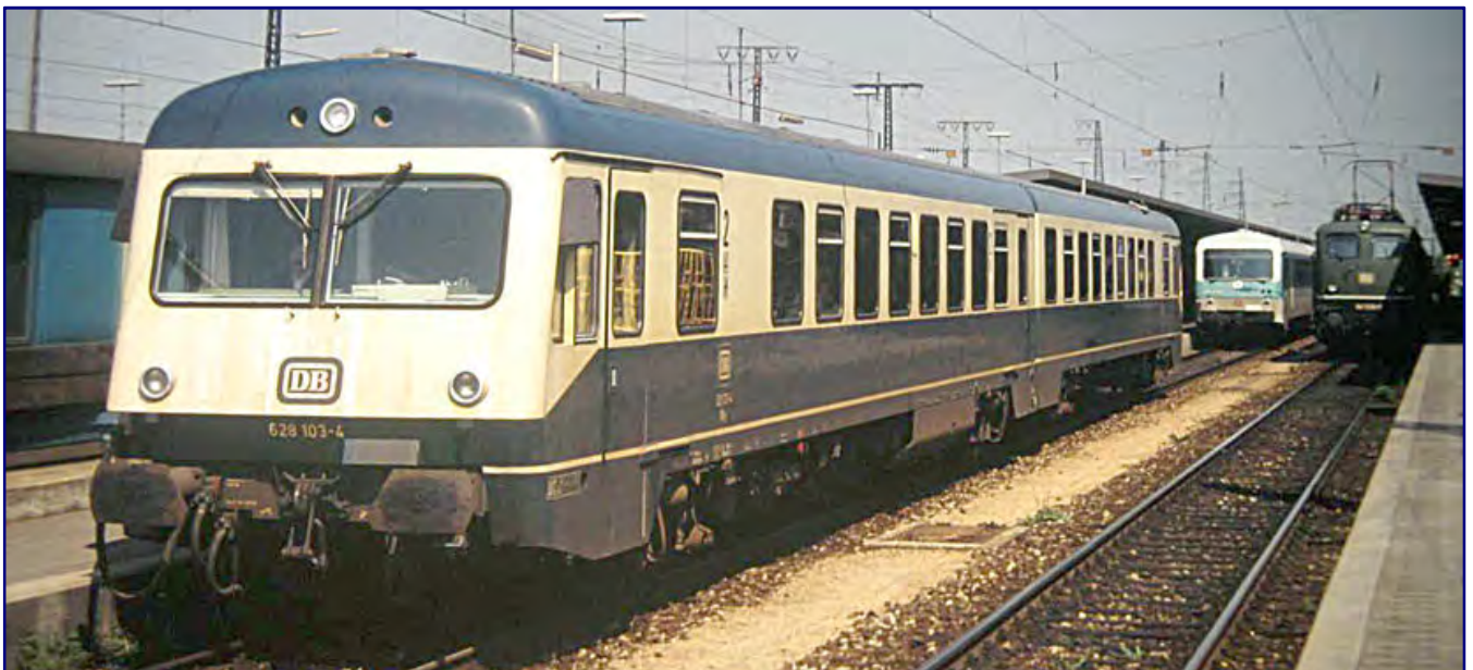
Als 628 103-4 am 17. Mai 1989 in Augsburg Hbf steht, erlaubt diese in nur drei Exemplaren beschaffte Unterbaureihe einen direkten Vergleich mit einem Serienfahrzeug: Die Längssicken sind verschwunden, die Front trägt nun den markanten Horizontalknick, doch die Position der Laternen und Typhone (neben dem oberen Spitzenlicht) entspricht noch den ersten Mustern der Baureihen 627 und 628. Foto: Benedikt Dohmen; CC BY-SA 3.0
