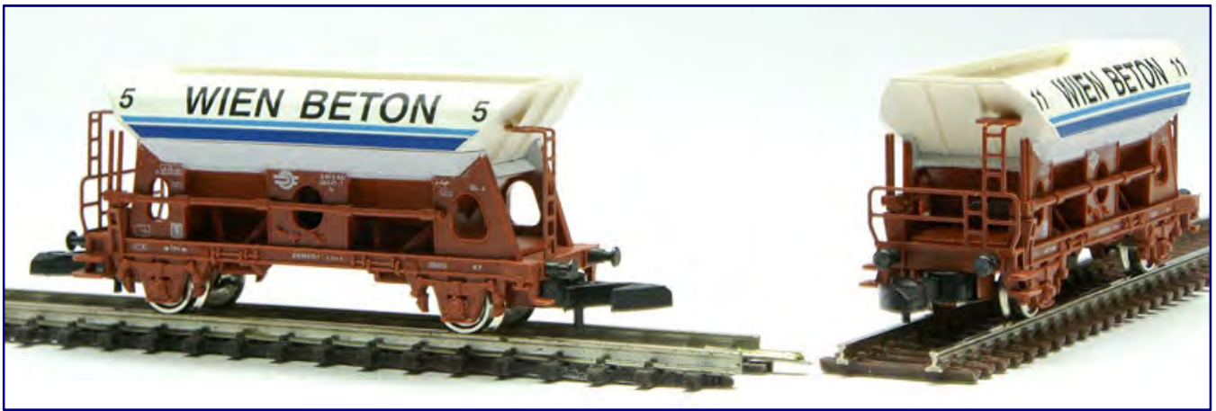
Im Direktvergleich zum Märklin-Gleis (links) zeigt sich das feinere Gleisprofil, das sich auch auf die Gesamthöhe des Gleises positiv auswirkt. Märklin-Räder laufen trotzdem problemlos über das Atlas-Gleisstück, ohne auf den Kleisenen aufzusetzen.
