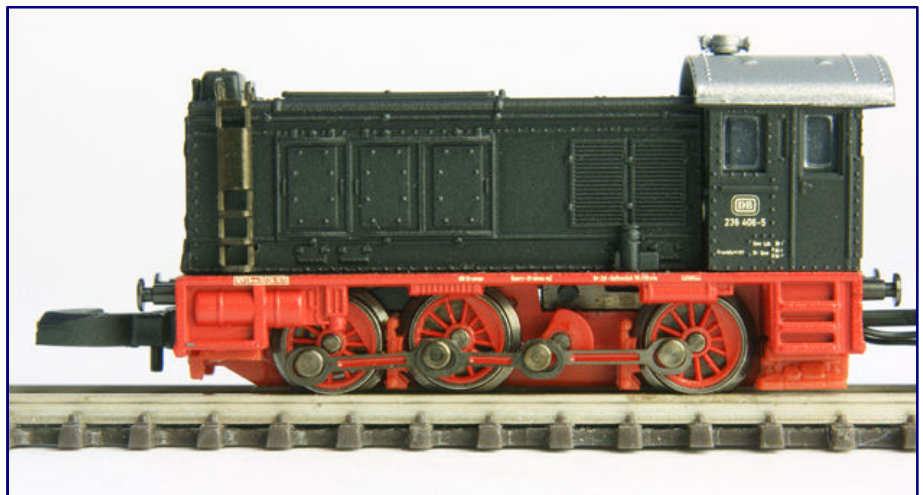
Die Aufstiegsleiter ist für eine Lok der Unterbaureihe V 36 4 zu weit hinten platziert und auch das Dach ist zu hoch wie auch zu stark ausgerundet. Die am Modell umgesetzten Merkmale gehören stattdessen zur Unterbaureihe V 36 1+2 , also dem Vorbild der Bahls-Lok.
