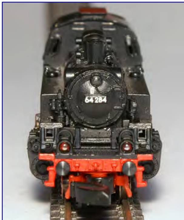
Die unteren Loklaternen wirken sehr groß, sitzen aber bündig über den Pufferbohlen. Weit zu den Seiten laden die Dampfzylinder aus, was nicht ganz dem zierlichen Vorbild entspricht.
