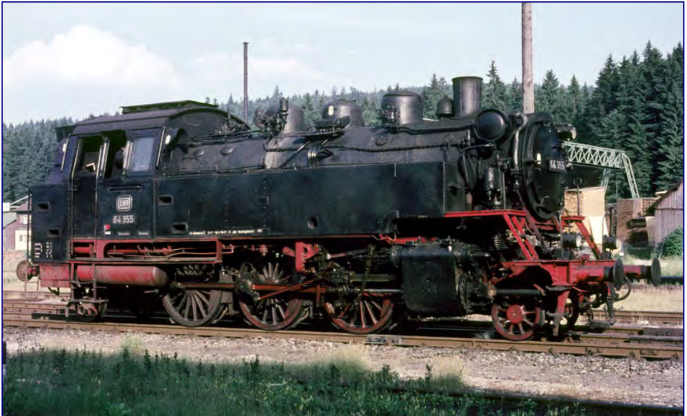
Auch 64 355 zeigt 1965 in Bayerisch Eisenstein das typische Aussehen einer DB-Maschine ihrer Baureihe: zweistufige Luftpumpe, Reflexglaslampen, rote Leitern sowie Rauchkammerträger und den roten Punkt am Führerhaus zur Kennzeichnung der Stahlfeuerbüchse. Deutlich ist am Reglerdom die Dampfefe zu sehen, die dem Märklin-Modell fehlt. Foto: Archiv Petkelis
