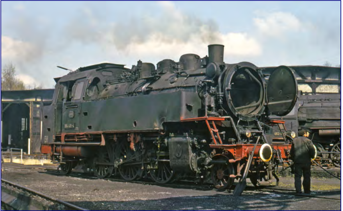
Als am 22. April 1972 im Bw Rottweil die Rauchkammer von Flugasche gereinigt wird, zeigt sich 064 491-4 mit roten Aufstiegsleitern zum Umlauf in typischer Form. Auf der Pufferbohle sitzen kleine DB-Reflexglaslampen. Foto: Will A. Reed, Archiv Eisenbahnstiftung
