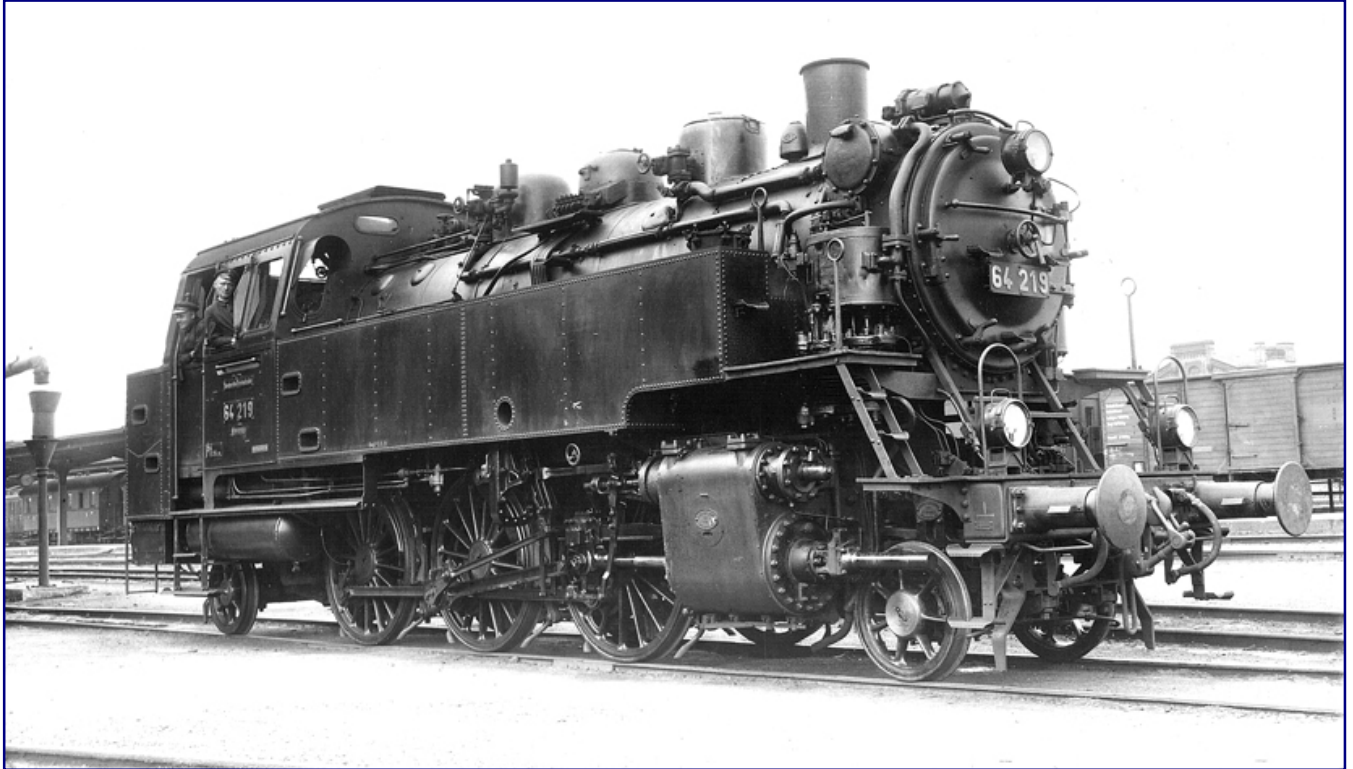
1930 ist 64 219 mit selbsttätigen Druckausgleichkolbenschiebern und kurzem Lüfteraufsatz auf dem Führerhausdach unterwegs. An der rechten Rauchkammerseite ist zudem die große Doppelverbundluftpumpe zu sehen, mit denen der Bubikopf ursprünglich ausgerüstet war. Foto: Werner Hubert, Archiv Eisenbahnstiftung
