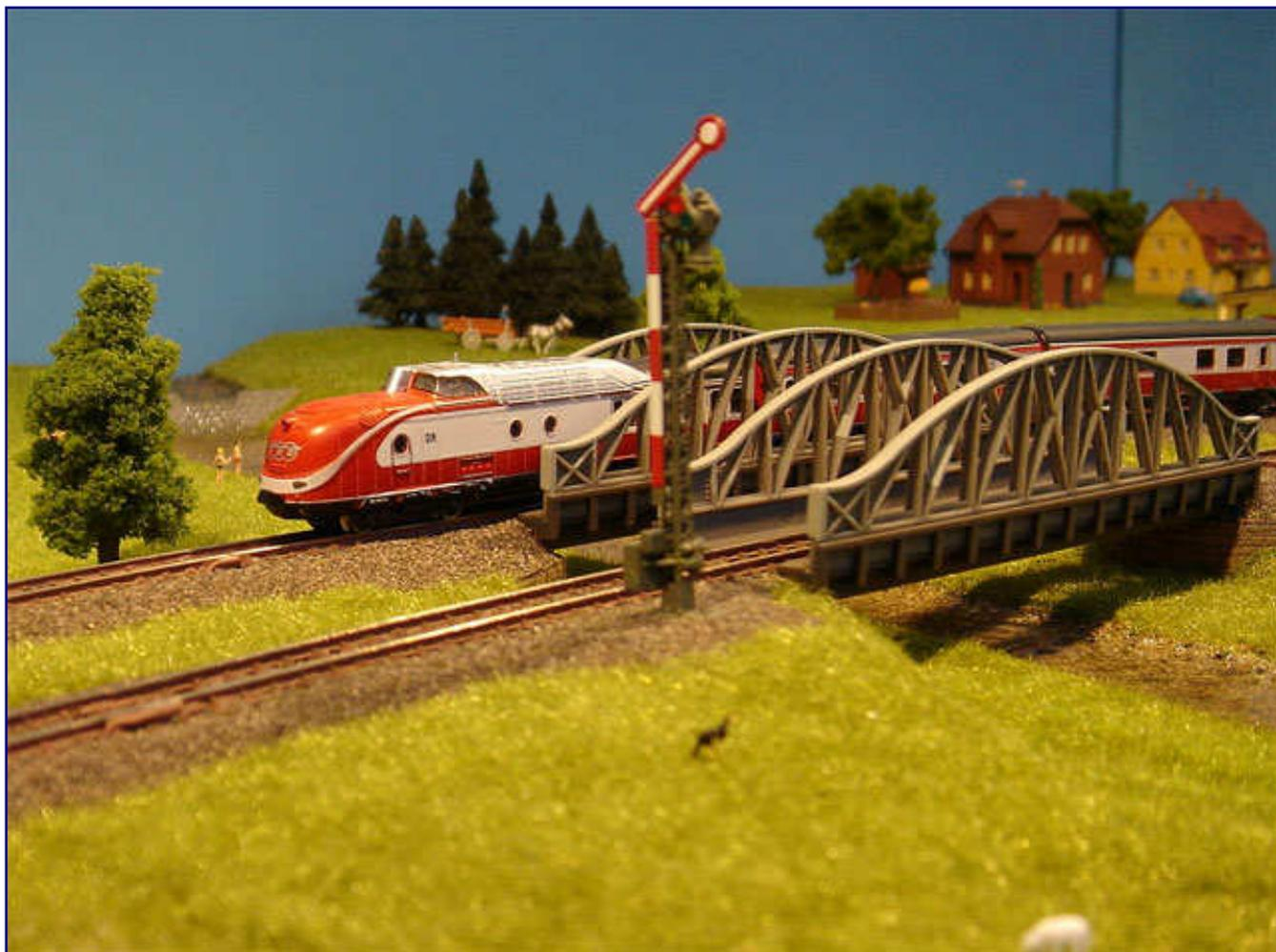
Die zweite Ausführung 88731 war bereits technisch überarbeitet: Neben den Kurzkupplungen wurden auch die Wagenübergänge neu gestaltet. Äußerlich unterschied sich der Zug deutlich durch die aufgedruckten Klassenbezeichnungen, lichtgrauem Streifen und dem DR-Schriftzug an den vorderen Triebkopfseiten. Hier ist der IC „Max Liebermann“ der Deutschen Reichsbahn auf einem Modul von Volker Bastek (ZSRR) unterwegs.
